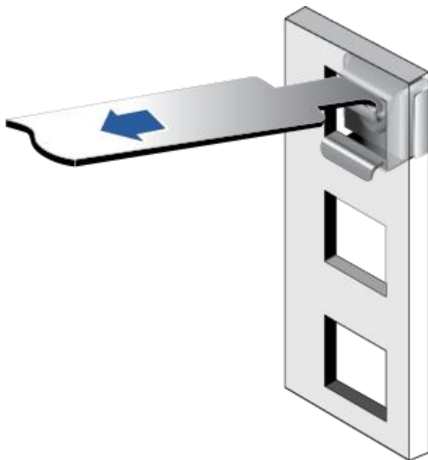
图 6-4 在机柜中安装浮动螺母
