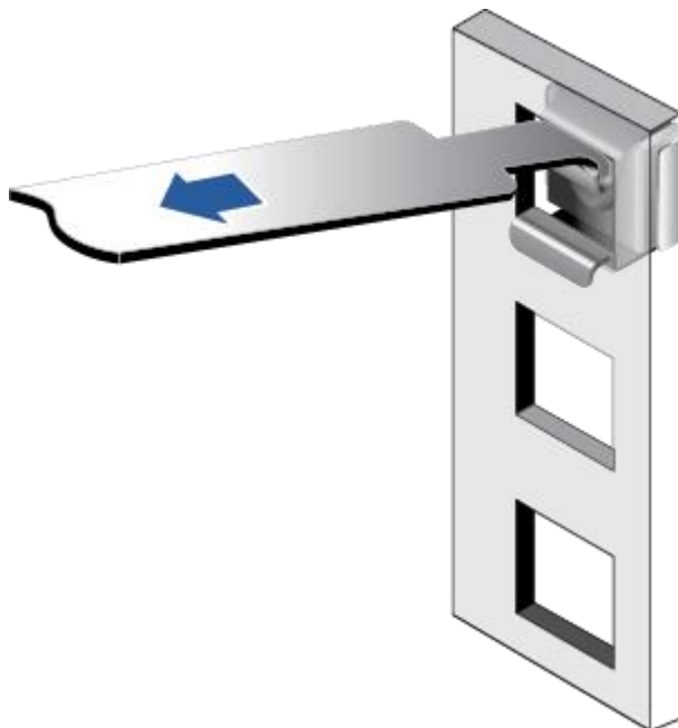
图 6-5 在机柜中安装浮动螺母
